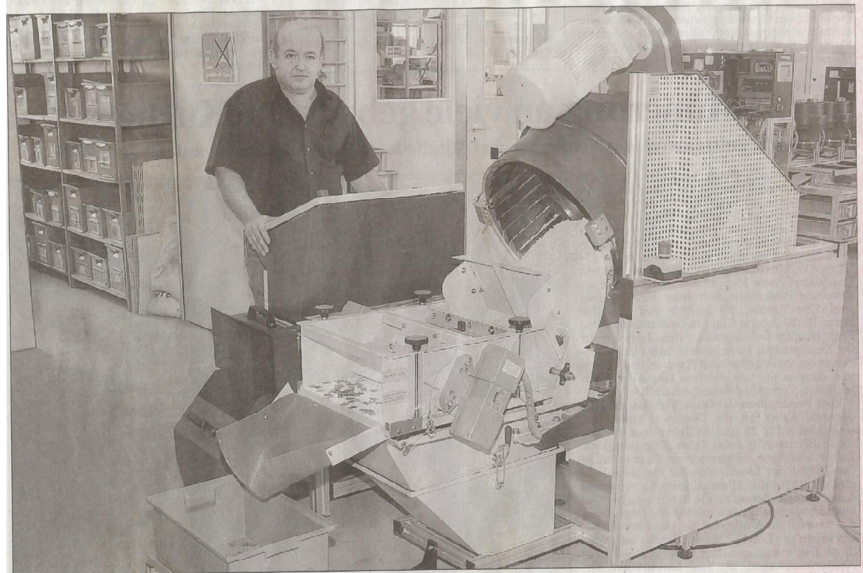
MODERNSTE GLEITSCHLEIFTECHNIK zur Oberflächenbearbeitung: Entwicklungschef Thomas Gegenheimer, Bruder des Firmengründers, bedient eine automatisierte CF 50-Tellerfliehkräftenanlage, bei der nach Entloeren der Trommel das Schleifgranulat durch ein Rüttlersieb von den bearbeiteten Werkstücken getrennt wird. Foto: Chris Heinemann
