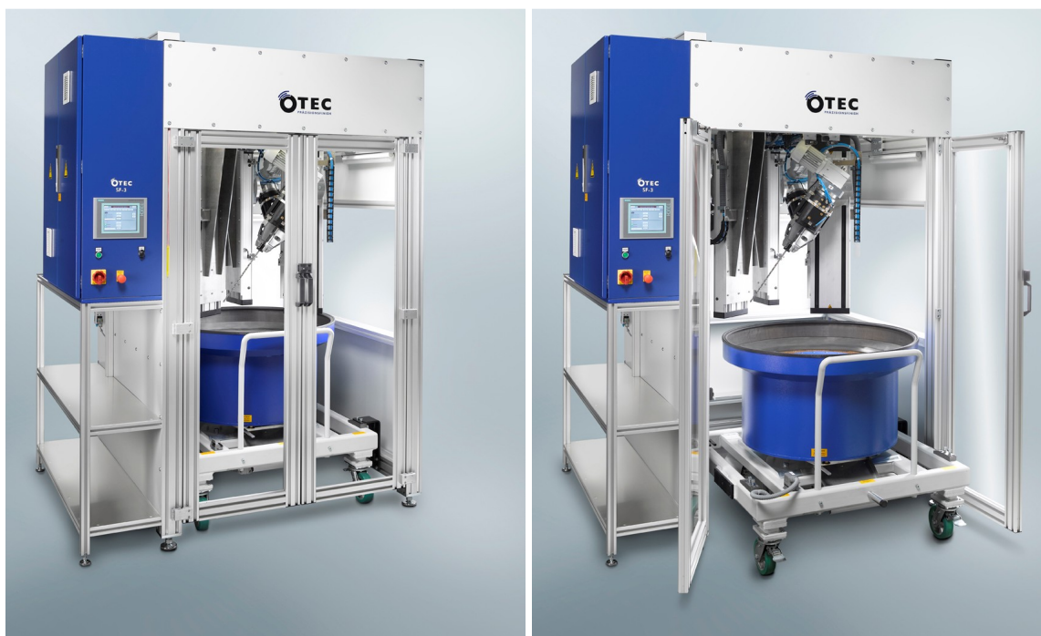
Maszyna SF z 3 uchwytami wyrobów; pojemnik jest zamocowany na wózku co ułatwia wymianę wsadu.
