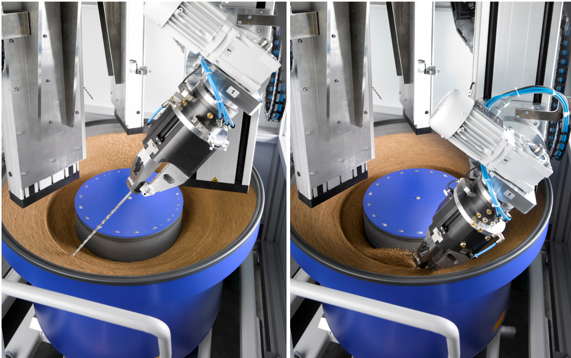
Zastosowanie: Polerowanie długich wiertel węglkowych
