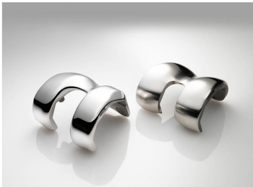
Bild 2: Kniegelenk nach der Bearbeitung und vor der Bearbeitung (Bild: OTEC)
